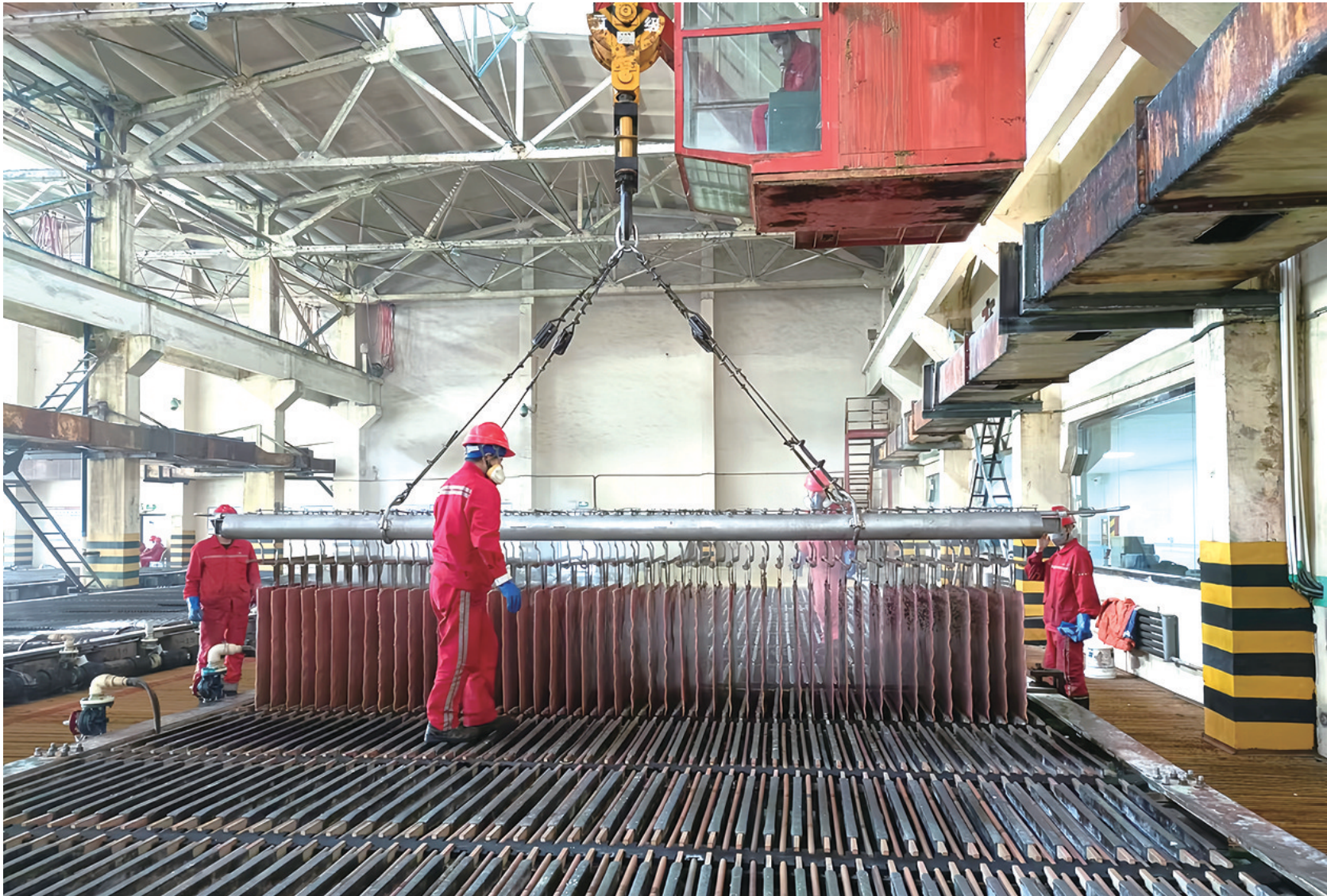
新春伊始，新疆新鑫矿业股份有限公司阜康冶炼厂抢时间、忙生产、抓建设，开足马力争创新年“开门红”。2月23日，在新疆新鑫矿业股份有限公司阜康冶炼厂的阴极铜生产车间，工人们正在生产线上忙碌着，一摆摆阴极铜板经过称重、分拣、配板、打包、贴标等多道工序后，销往北京、上海等地。
