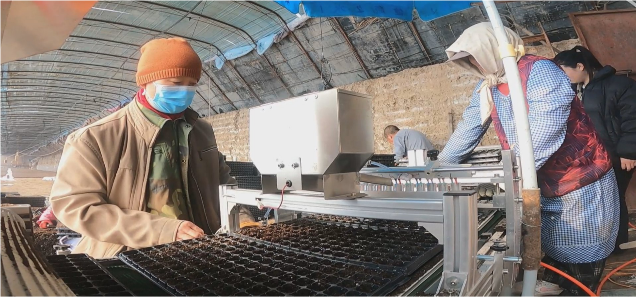
3月4日，在玛纳斯镇上二工村现代设施农业种植基地，种植户正在使用全自动穴盘育苗点种机点种加工番茄苗。 □瓦力斯江·乌马尔江摄
