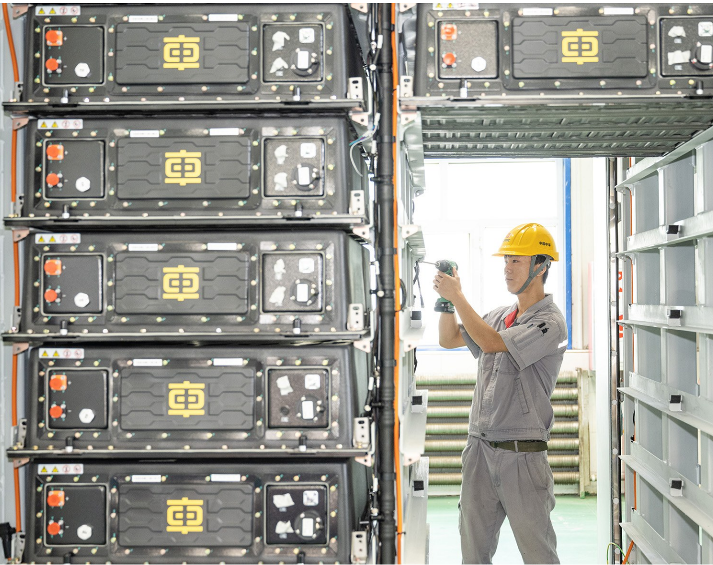
6月3日，中车株洲所新疆昌吉新型储能基地，工作人员在生产储能直流舱。
