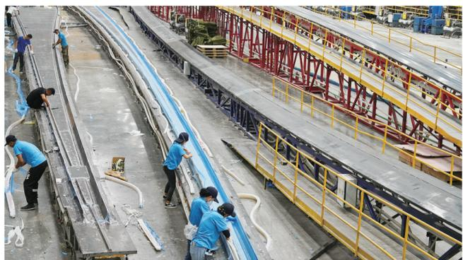
9月12日,新疆东方风电新能源有限公司生产车间,工人正在进行风机叶片铺层、组装等工作。
