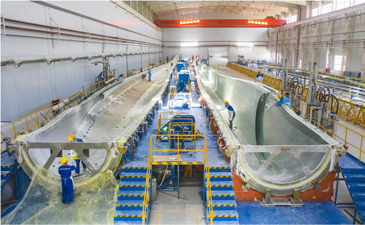
昌吉国家高新技术产业开发区新疆成飞新材料有限公司风电叶片生产车间,工作人员在生产风力发电机组叶片。
