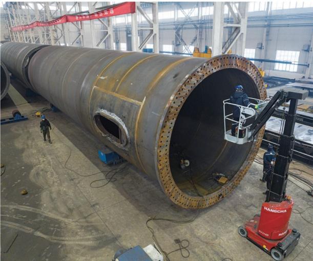
1月16日，昌吉州泰胜风能风电设备有限公司车间，工人正在生产风力发电机塔筒。昌吉州泰胜风能风电设备有限公司年产10万吨风电塔架项目是木垒县2024年的重点建设项目之一。该项目于去年9月投产，对木垒县“新能源+”产业链聚集融合、集群发展具有重要意义。 □本报记者 巨海成摄
