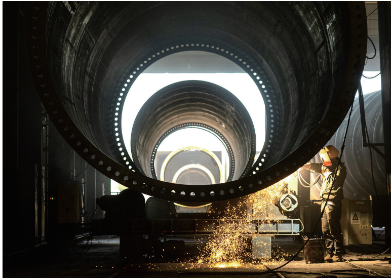
2月17日，位于奇台县喇嘛湖梁工业园区的新疆骏晟能源装备有限公司生产车间里，工人正在生产风力发电机塔筒。
