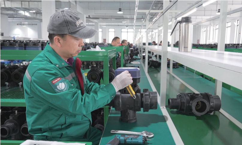
技术人员正在组装智慧电动球阀。 □邢振江摄
