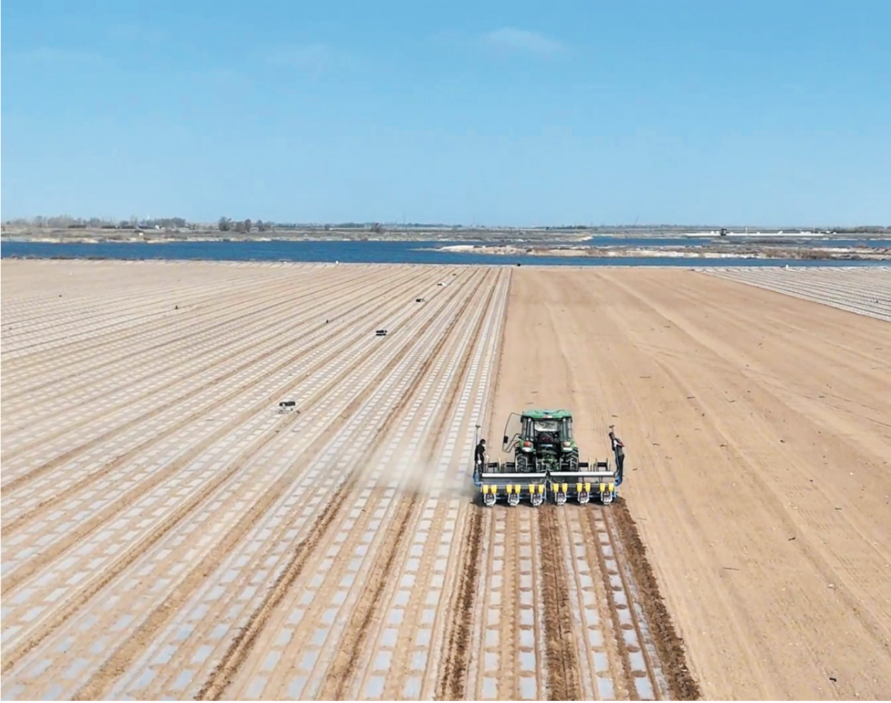
4月11日,在玛纳斯县北五岔镇大庙村经济合作社的高标准条田里,搭载北斗导航系统的精量播种机正在进行棉花播种作业。 □朱文斌摄
