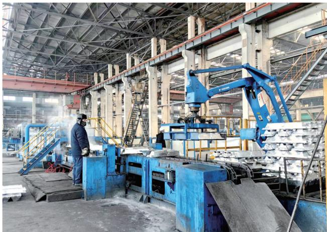
图为新疆嘉润资源控股有限公司铸造车间,码垛机器人抓取铝锭进行堆放。
