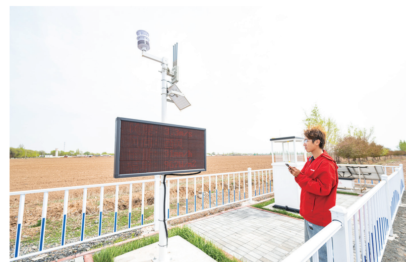
4月18日,昌吉国家农业高新技术产业示范区智慧农场,新疆慧尔智联技术有限公司技术人员在调试气象监测设备。
