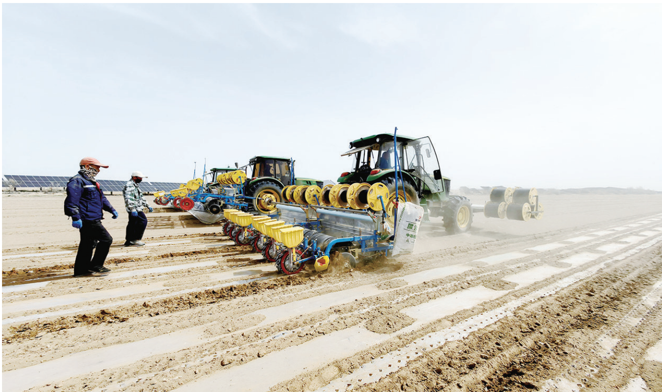
4月19日,玛纳斯县北五岔镇田家井村,3台搭载北斗导航系统的精量播种机在田间齐头并进进行播种作业。
