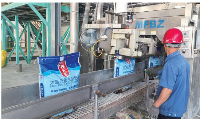
新疆云图水溶肥有限公司智能化生产车间内,年产10万吨的水溶复合肥生产线正开足马力生产。
