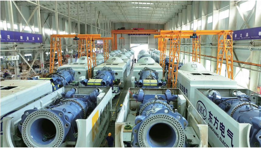
图为新疆东方风电新能源有限公司生产的6.7兆瓦风机主机。
