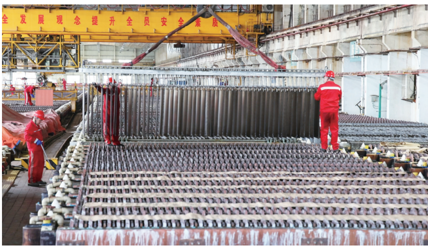
近日，在新疆五鑫铜业有限责任公司电解车间内，工人将阴极铜板放入电解槽。
