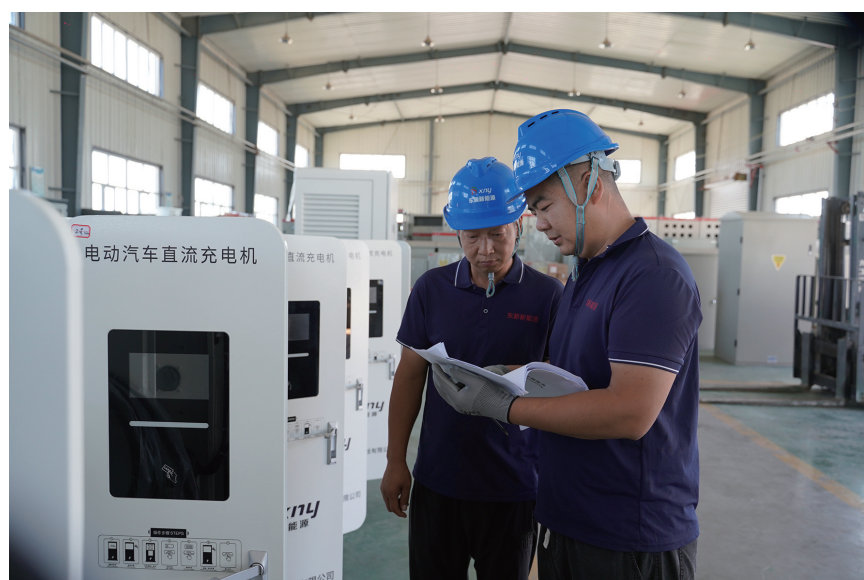
7月15日,在新疆东新能源科技有限公司装配车间,技术人员在进行充电桩投用前最后的检查调试。 □李逸凡摄
