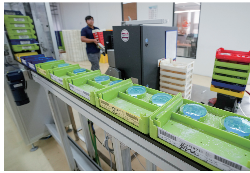
这是江苏洪旭德生科技有限公司生产车间内的自由曲面数字镜片加工生产线(9月27日报)。
