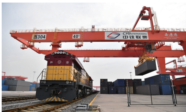
11月14日，在西安国际港站，龙门吊在吊装集装箱。
