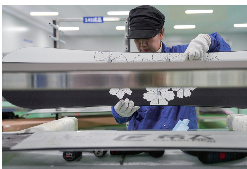
12月4日，在吉林化纤国兴复合材料有限公司车间内，工作人员复检公司自主研发生产的碳纤维滑雪板。
