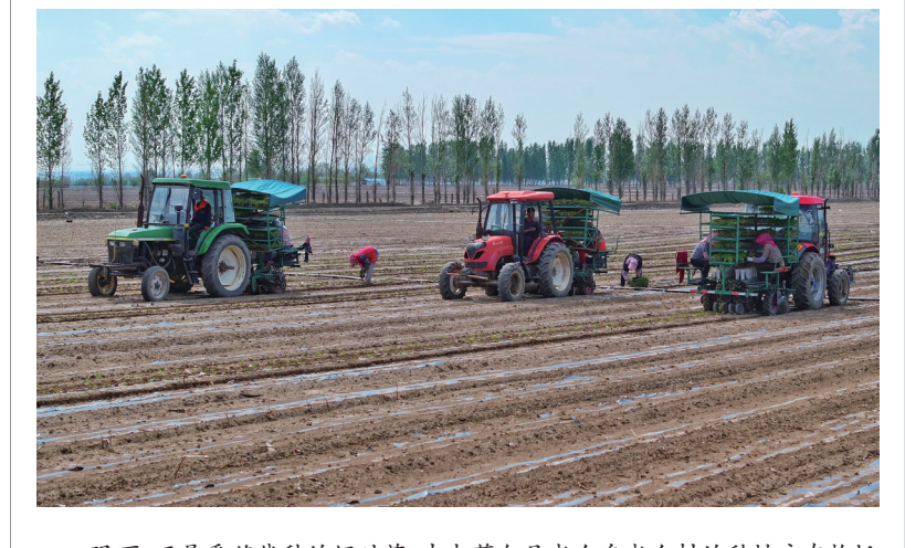
眼下，正是番茄栽种的好时节。吉木萨尔县老台乡老台村的种植户在抢抓农时，栽种番茄苗。图为农户在运用番茄移栽机移栽番茄苗。 □冯晓阳摄
