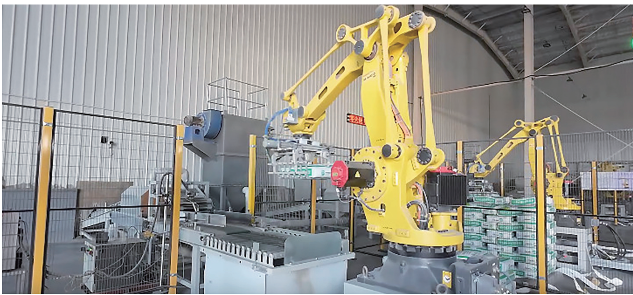
新疆奇能盛达环保科技有限公司生产车间，码垛机器人正在作业。
